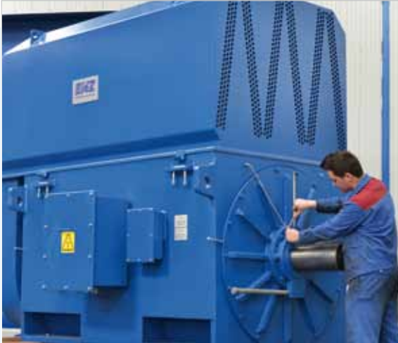
AKL 710-06, 2.500 kW, 6.000 V, 990 rpm für Ventilator
