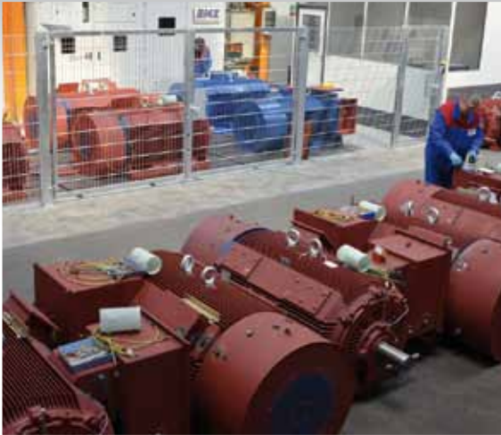
EMZ AKR Motoren bei der Stückprüfung
