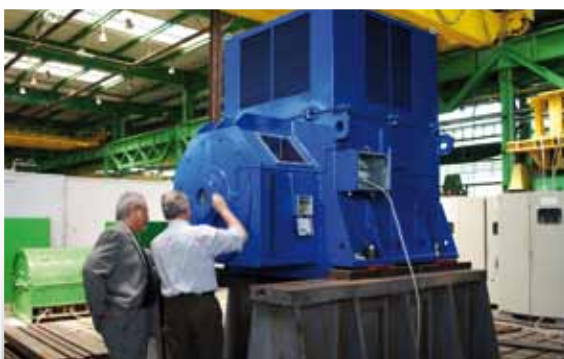
Lastlauf für den Ersatzmotor EMZ ASD 630-06, 1.700 kW, 10.000 V, 990 rpm
