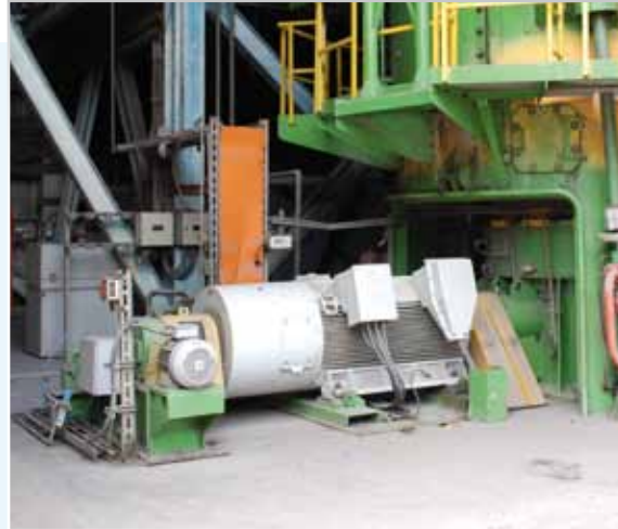
Kohlemühlenantrieb in Malaysia Siemens Type 1LS1 454-6, 350 kW
