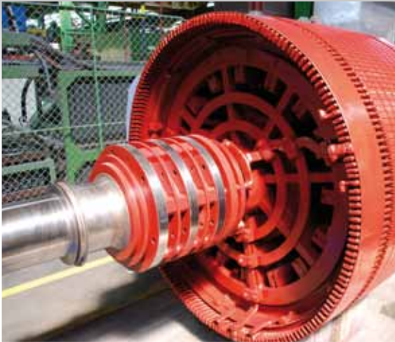
Rotorneuwicklung Schleifringläufermotor 1.700 kW mit Neukonstruktion des Schleifringkörpers
