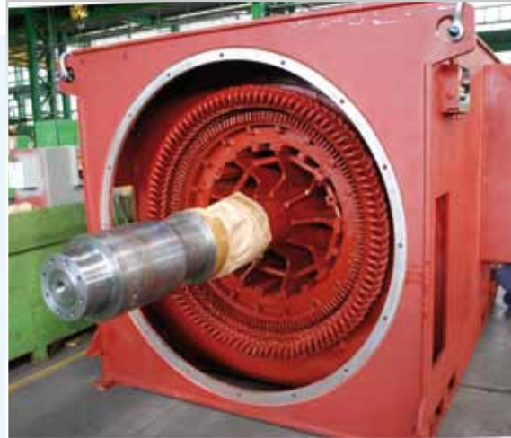
Neuwicklung Stator & Rotorwicklung BBC Motor 4.500 kW, 10.000 V, 495 rpm
