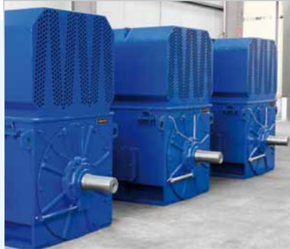
AKL 560-06, 1.200 kW, VFD für WT Gebläse
