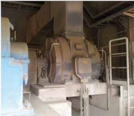
Kugelmühlenantrieb Originalmaschine 1.700 kW, 10.000 V, 990 rpm
