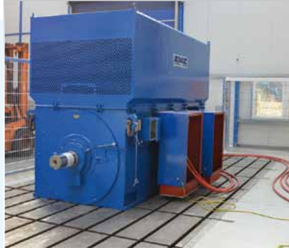
Mühlenantrieb ASL 630-06 im EMZ Prüffeld 4.200 kW, 4.160 V, 60 Hz, 1.190 rpm
