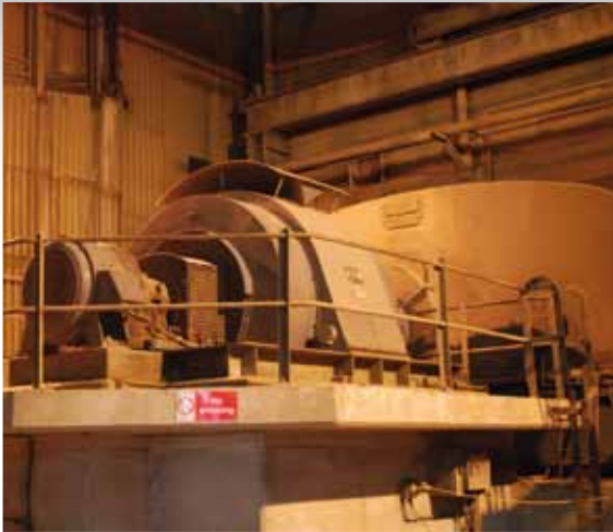
Kugelmühlenantrieb in UK, Baujahr 1967 1.700 kW, 11.000 V, 500 rpm
