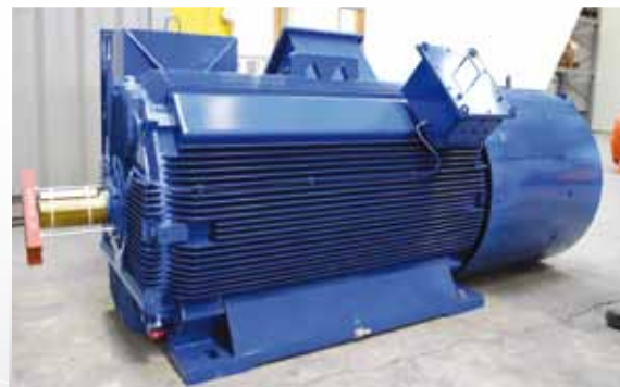
Ersatzmotor EMZ AKS 450-06, 350 kW, 6.000 V, 990 rpm
