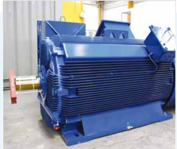
Schleifringläufer ASR 450-06 für Kohlemühlenantrieb
