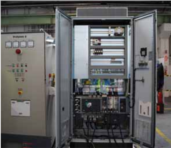
Frequenzumrichter 1.200 kW bei der Werksabnahme
