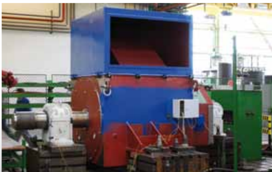
Ersatzmotor während der Kundenabnahme 1.700 kW, 11.000 V, 494 rpm
